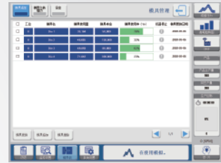
实时控制模具寿命， 寿命将尽时报警停止
